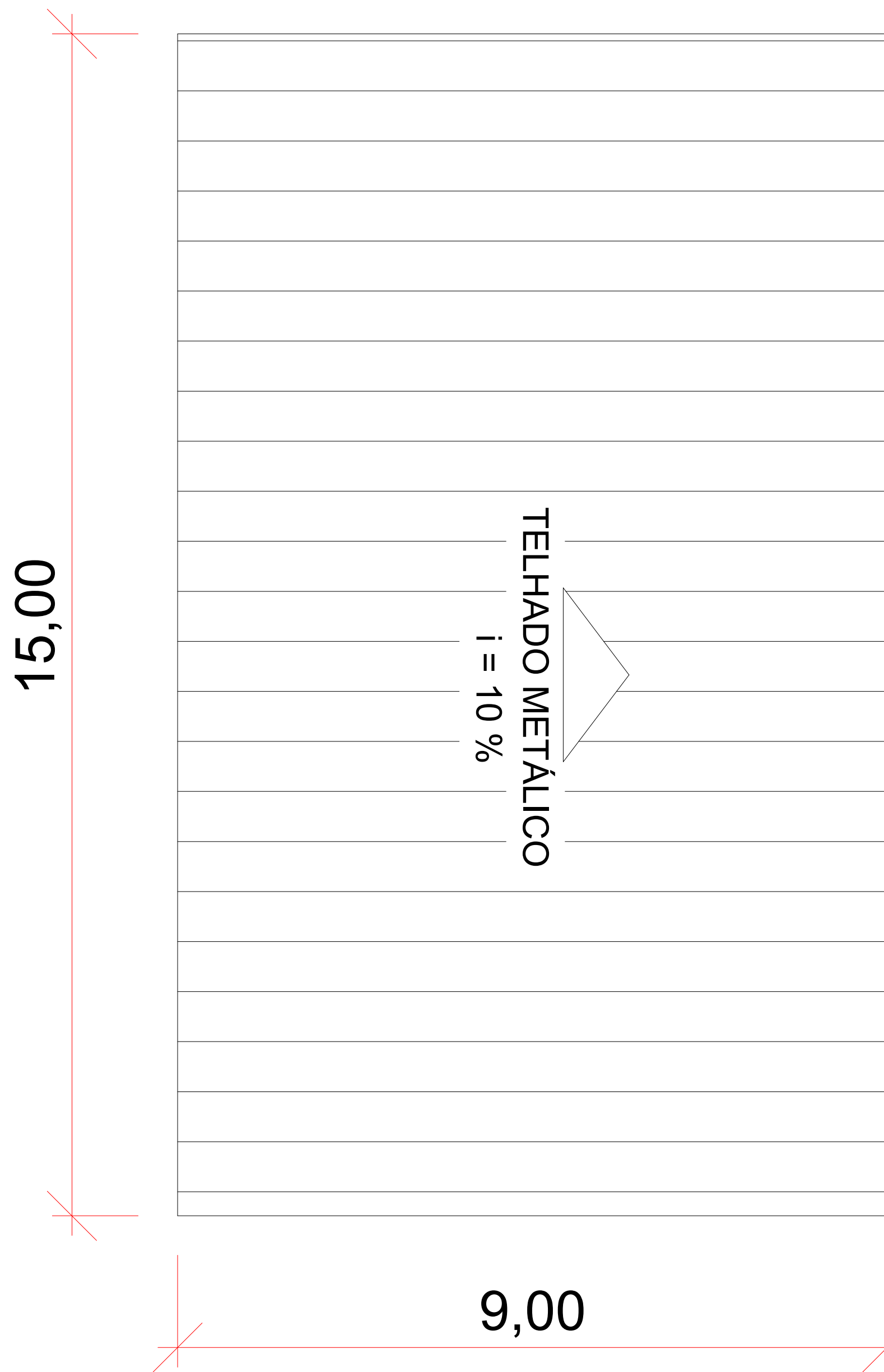
PLANTA DE COBERTURA (GALPÃO) ESC.: 1/50
